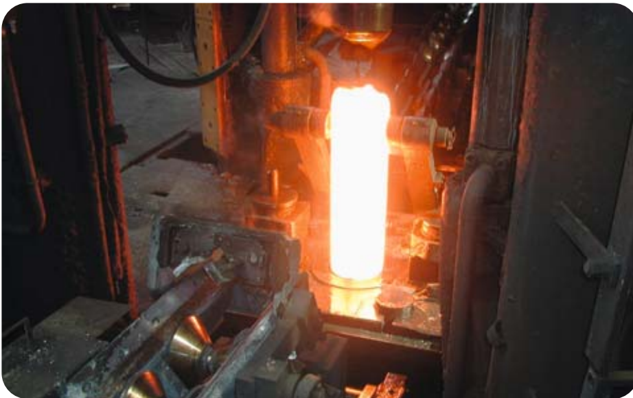
Auf der Lochpresse wird aus dem glühenden Stahlblock die Rohrhülse.
