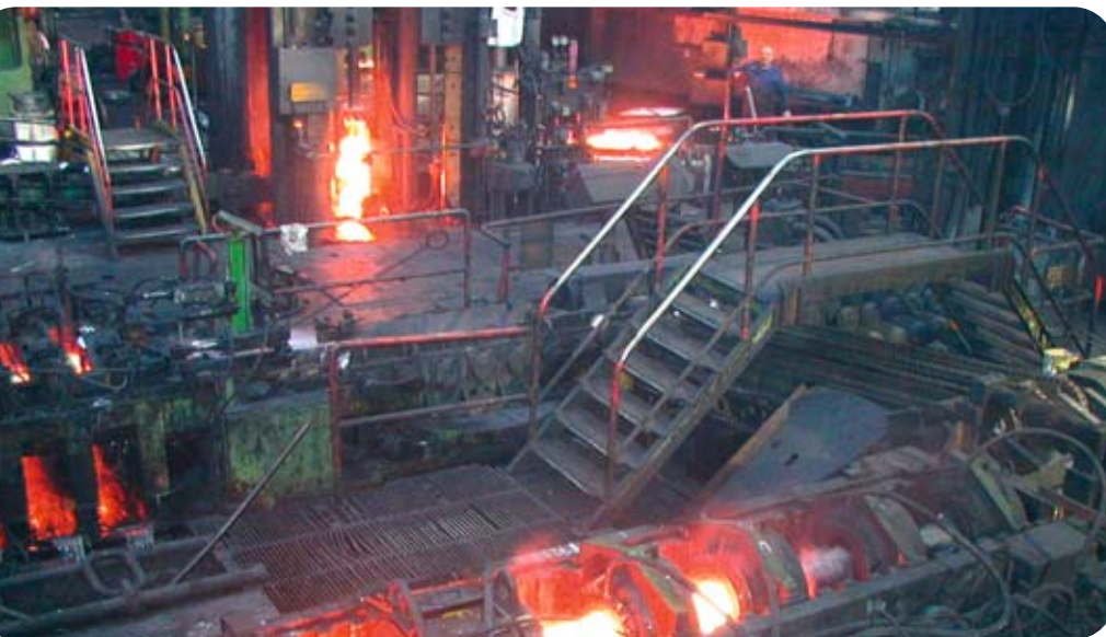
Mit einer Kraft von 90 Tonnen entsteht das Stahlrohr auf der Stoßbank.
