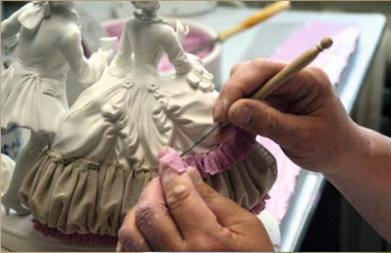
Alles aus Porzellan: Sogar der Spitzenbesatz an der Bekleidung von Porzellanfiguren wird in den Manufakturen von hand geformt und angebracht.
