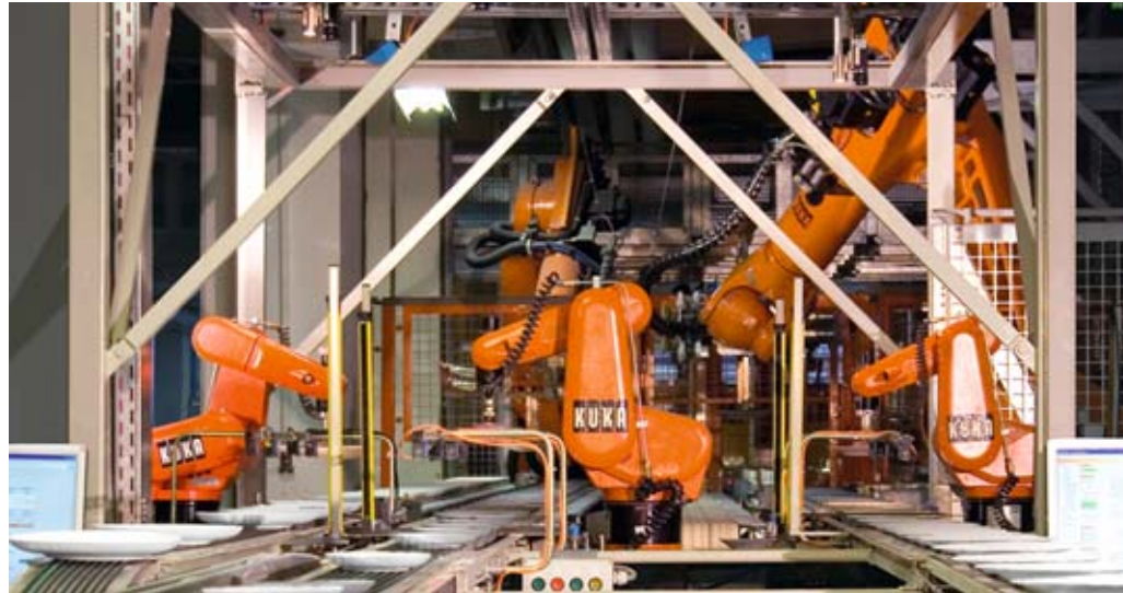
Über 70 Industrieroboter übernehmen im Werk Erbdorf grundlegende Arbeitsschritte wie das Formen der Teile vor dem Brand.
