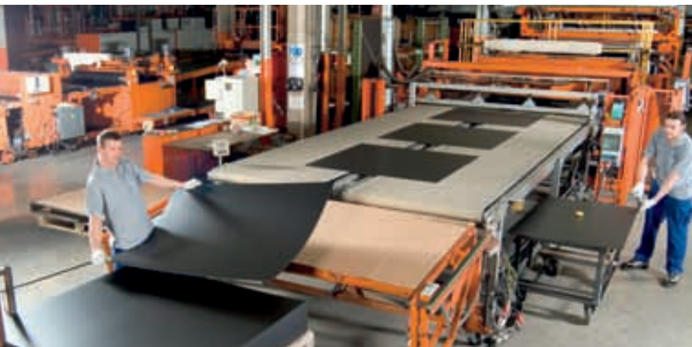
Zurecht geschnitten und abgekühlt laufen die frisch produzierten Kunststoffplatten aus dem Extruder.
