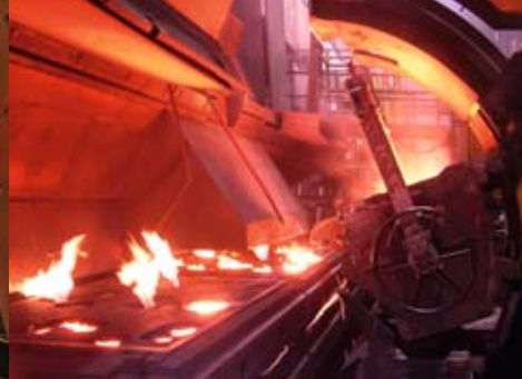
Befüllen der Gussformen mit flüssigem Eisen.
