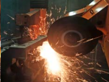
Seit 2007 übernehmen teilweise Roboter das Putzen der Gussteile.
