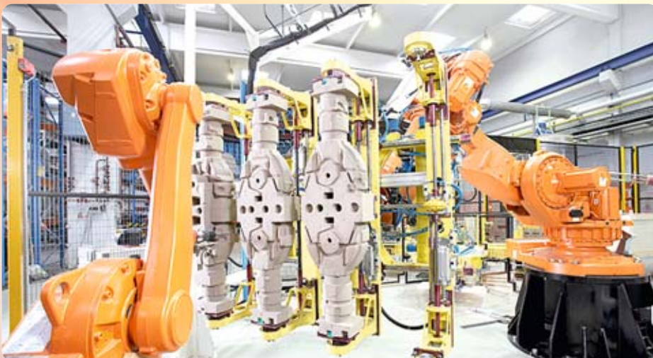
Automatisierte Herstellung der Formkerne, die den späteren Hohlräumen in den Gussteilen entsprechen.
