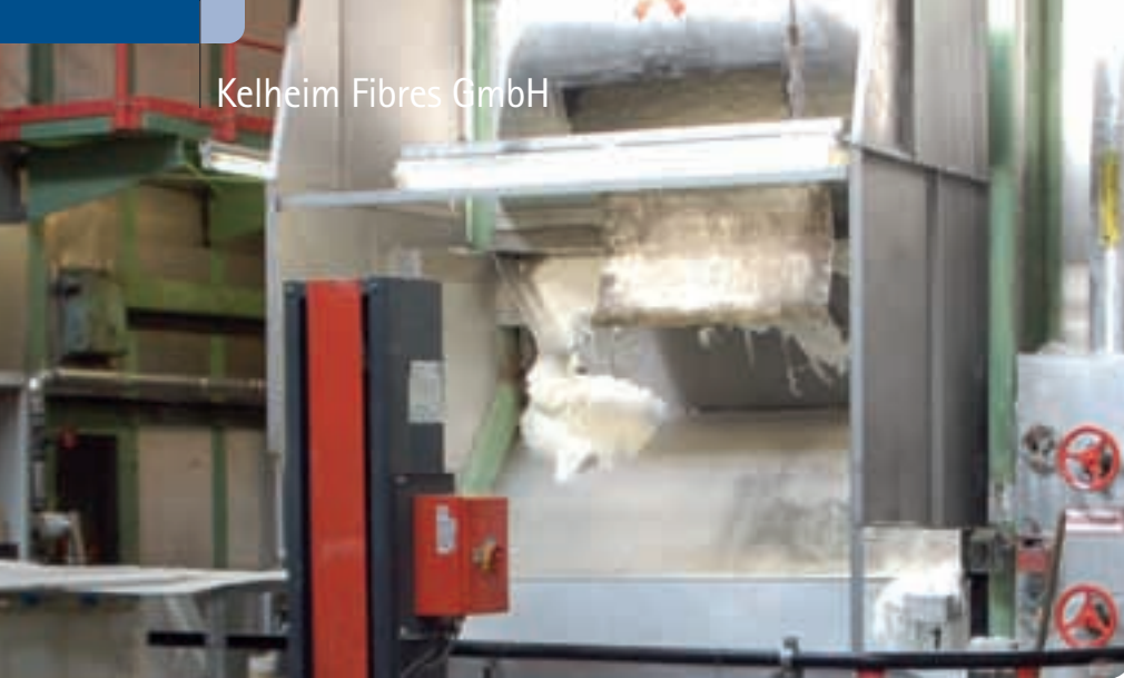
Am Ende der Produktionsstraße fallen die geschnittenen Fasern aus der Anlage, fertig zur Verpackung.
