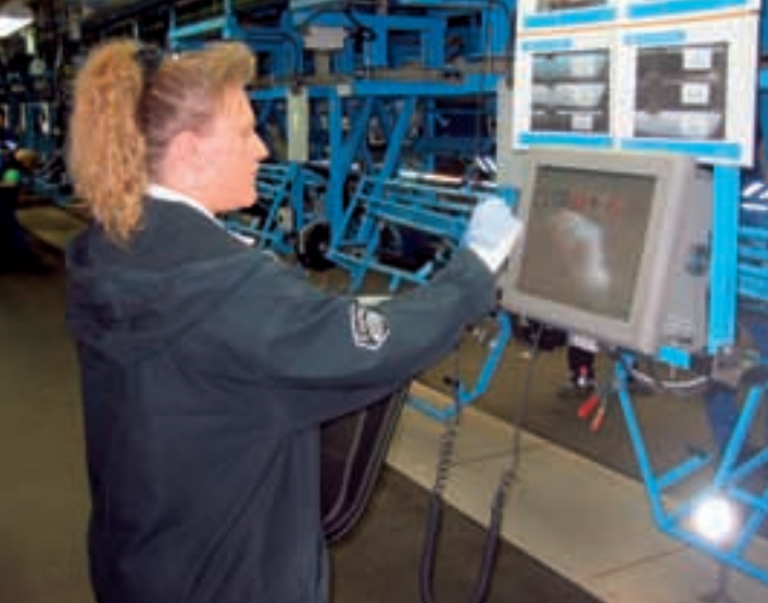
Als Endkontrolle, ob die Türverkleidung so gebaut wurde wie der Kunde sie bestellt hat, tippt die Mitarbeiterin beim Blind Audit alle Spezifikationen in den Computer.
