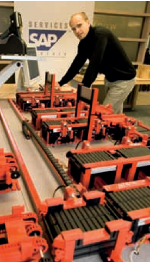
An einem Fischertechnik-Modell erläutern die Mitarbeiter von IGZ den Kunden die Abläufe und deren Steuerung in automatischen Hochregallagern.
