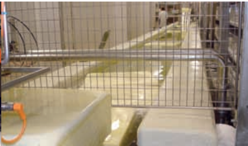
Die Käselaibe durchlaufen vollautomatisch das Salzbad.
