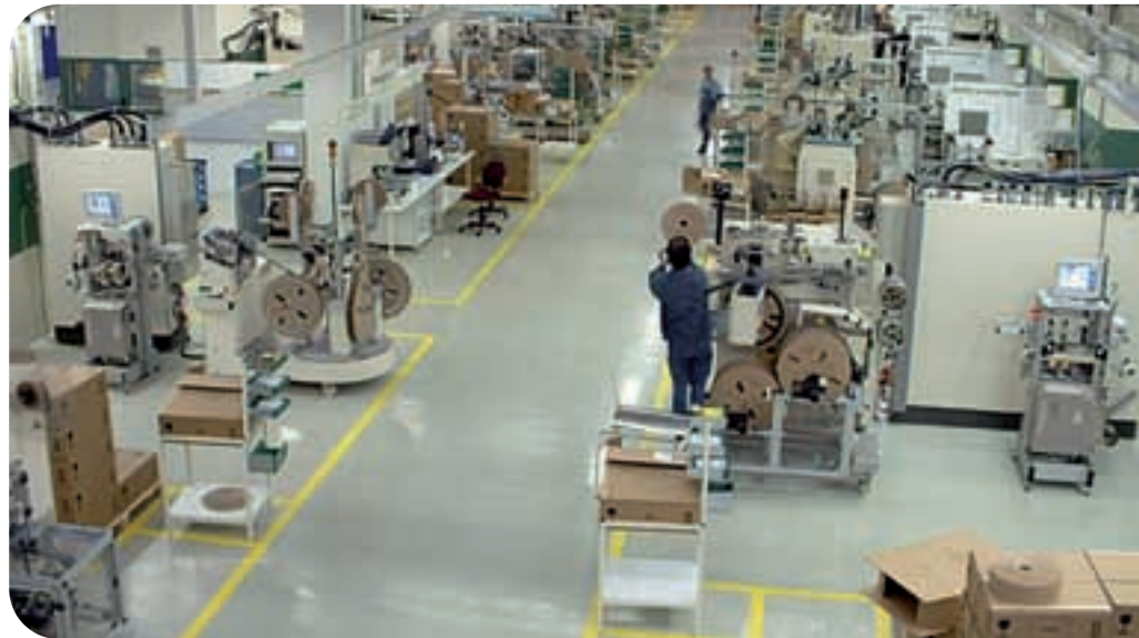
24 Hochgeschwindigkeits-Stanzpressen fertigen 2,4 Milliarden Stanzteile pro Jahr.
